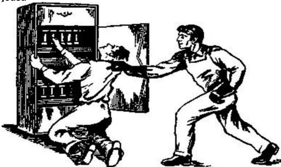
Figura 4. Eliberarea victimei de părțile instalației aflate sub tensiune cu folosirea mijloacelor de protecție.
